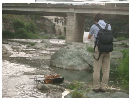
吉野町から持ち込んだ手作り水車で発電実験
