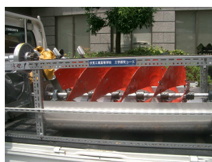
伏見工業高校作成のらせん式水車発電機
