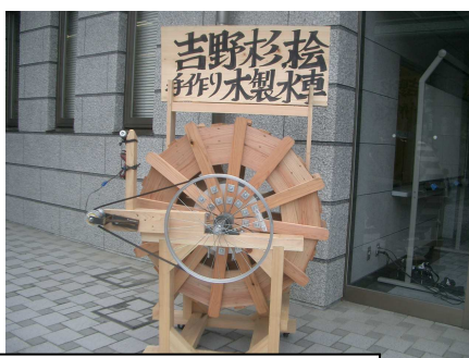
伏見工業高校作成のらせん式水車発電機
