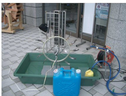
吉野町から持ち込んだ手作り水車で発電実験
